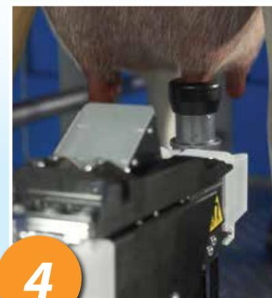
4 Jede Zitze wird mithilfe eines speziellen Vormelkbechers individuell auf schonende, zügige und vollständige Weise für das Melken vorbereitet. Der gesamte Vormelkprozess bietet ein optimales Verfahren für die Zitzenreinigung, die Zitzenstimulation, das Vormelken und die maximale Oxytocinproduktion für ein optimales Einschleusen
