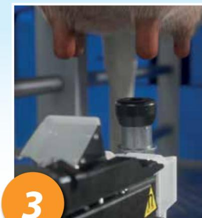
3 Der Roboterarm nähert sich dann durch die Hinterbeine der Kuh hindurch dem Euter. Mit neuester Kameratechnik wird die Position der Zitzen bestimmt.
